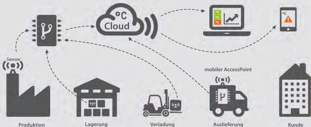
Bereits zu Produktionsbeginn platzieren Sie einen Sensor bei einem Produkt. Während allen weiteren Produktionsschritten bis hin zur Lagerung, Verpackung und Verladung werden in regelmäßigen Abständen die Temperaturdaten per AccessPoint an die Cloud übermittelt und so für Sie bereitgestellt. Selbst während der Auslieferung an Ihre Kunden wird per mobilem AccessPoint die Temperatur weiterhin automatisch dokumentiert und überwacht. **Lückenlos – einfach & sicher!**
